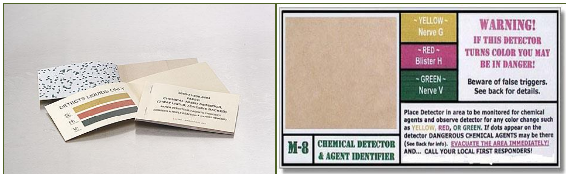
รูปภาพที่ ๒๗ กระดาศตรวจสอบสารพิษเคมี M 8
