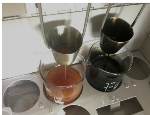
ภาพที่ ๑๓ วิธีตรวจสอบค่าความหนืด ขั้นตอนที่ ๔
