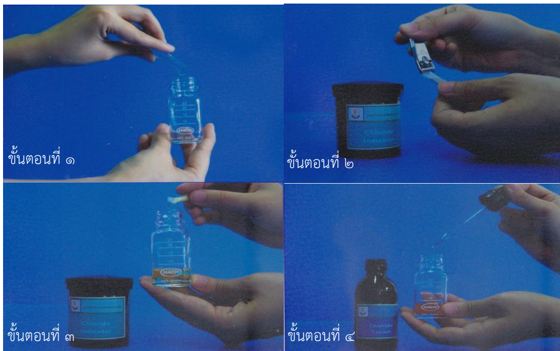
ภาพที่ ๔๓ แสดงวิธีวิเคราะห์ปริมาณคลอไรด์ (Chloride , Cl - )
