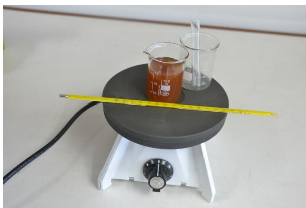
ภาพที่ ๑๘ อุปกรณ์ที่ใช้ในการตรวจสอบปริมาณน้ำในน้ำมันหล่อลื่น
