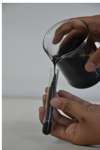
ภาพที่ ๒๐ วิธีตรวจสอบปริมาณน้ำในน้ำมันหล่อลื่นขั้นตอนที่ ๒ ๒.๑.๒.๓ จุ่มหลอดทดสอบจากข้อ ๒ ลงในบีกเกอร์ที่ร้อน ๒๐๐ องศาเซลเซียส เป็นเวลา ๒ นาที แล้วยกขึ้น ขั้นตอนนี้ให้ระวังอย่าให้ปากหลอดทดลองหันเข้าสู่ผู้ทดสอบ เนื่องจากถ้ามีน้ำปน อยู่ในน้ำมันหล่อลื่นมาก อาจเกิดการกระเด็น หรือพุ่งออกมาของไอน้ำเนื่องจากได้รับความร้อน
