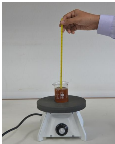
ภาพที่ ๑๙ วิธีตรวจสอบปริมาณน้ำในน้ำมันหล่อลื่นขั้นตอนที่ ๑ ๒.๑.๒.๒ เทน้ำมันที่ต้องการตรวจลงในหลอดทดสอบสูงประมาณ ๔ เซนติเมตร
