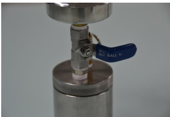
ภาพที่ ๒๔ วิธีตรวจสอบปริมาณน้ำในน้ำมันหล่อลื่นขั้นตอนที่ ๑
