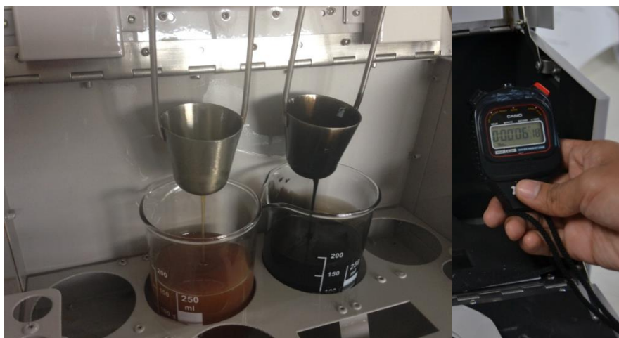
ภาพที่ ๑๔ วิธีตรวจสอบค่าความหนืด ขั้นตอนที่ ๕
