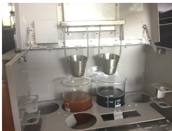
ภาพที่ ๑๐ วิธีตรวจสอบค่าความหนืด ขั้นตอนที่ ๑
