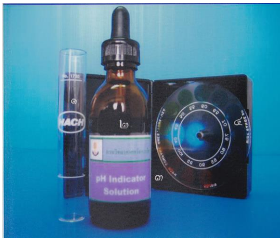
ภาพที่ ๓๘ อุปกรณ์และสารเคมีที่ใช้ในการตรวจวิเคราะห์ความเป็นกรด-ด่าง (pH)
