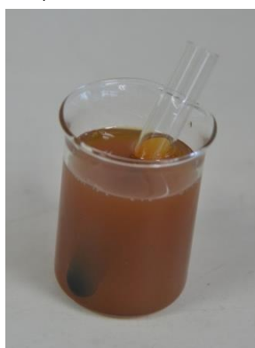
ภาพที่ ๒๑ วิธีตรวจสอบปริมาณน้ำในน้ำมันหล่อลื่นขั้นตอนที่ ๓
