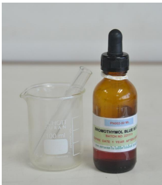
ภาพที่ ๓๔ อุปกรณ์ที่ใช้ในการตรวจสอบความเป็นกรดในน้ำมันหล่อลื่น
