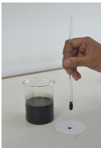
ภาพที่ ๓๒ วิธีตรวจสอบความสกปรกในน้ำมันหล่อลื่น ขั้นตอนที่ ๒
