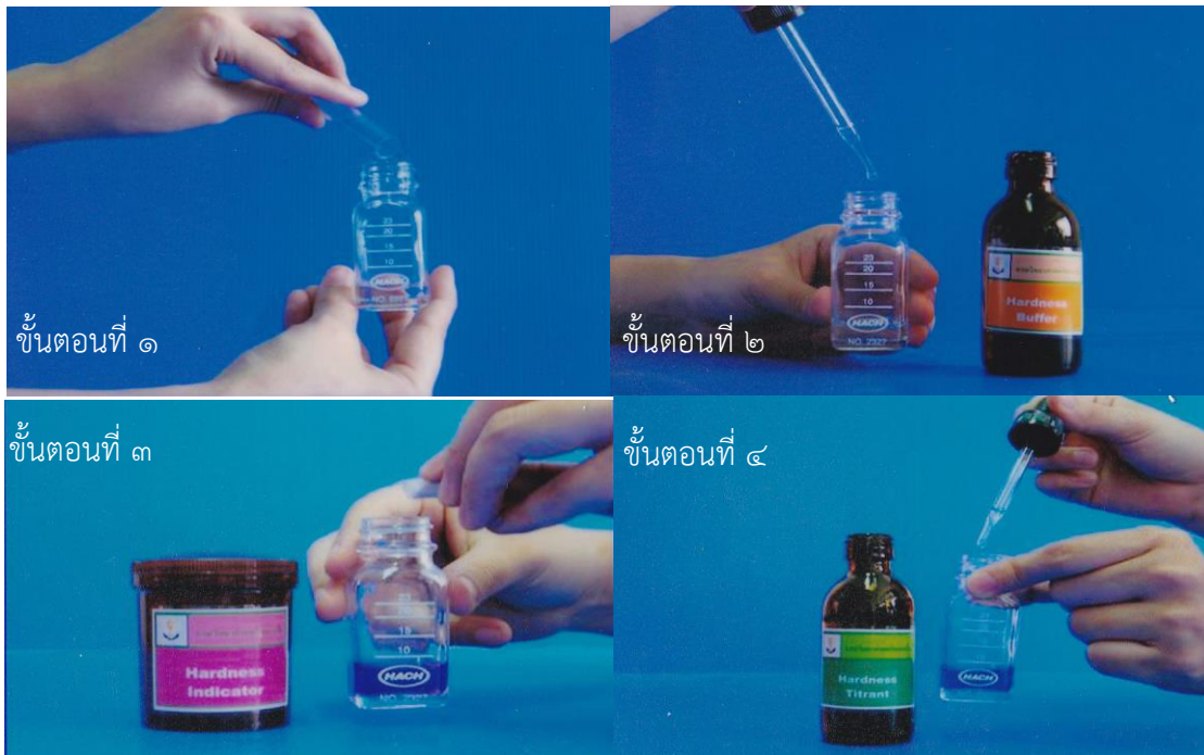
ภาพที่ ๔๑ แสดงวิธีวิเคราะห์ความกระด้างของน้ำ (Hardness)
