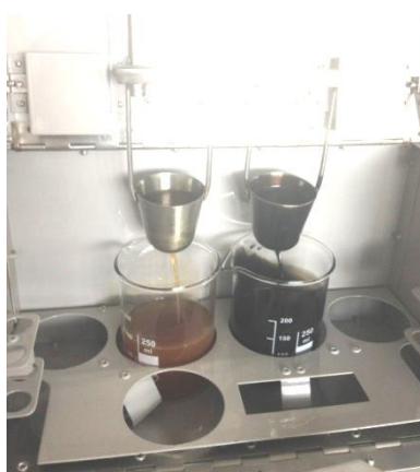
ภาพที่ ๑๒ วิธีตรวจสอบค่าความหนืด ขั้นตอนที่ ๓
