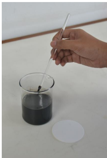
ภาพที่ ๓๑ วิธีตรวจสอบความสกปรกในน้ำมันหล่อลื่น ขั้นตอนที่ ๑
