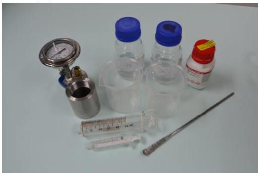
ภาพที่ ๒๓ อุปกรณ์ที่ใช้ในการตรวจสอบปริมาณน้ำในน้ำมันหล่อลื่นโดยการอ่านค่าความดันไอน้ำ
