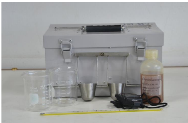
ภาพที่ ๙ อุปกรณ์ที่ใช้ในการตรวจสอบค่าความหนืด
