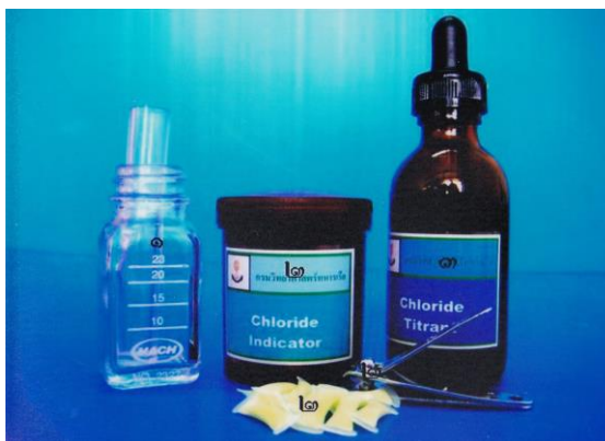
ภาพที่ ๔๒ อุปกรณ์และสารเคมีที่ใช้ในการตรวจวิเคราะห์ปริมาณคลอไรด์ (Chloride, Cl^- )
